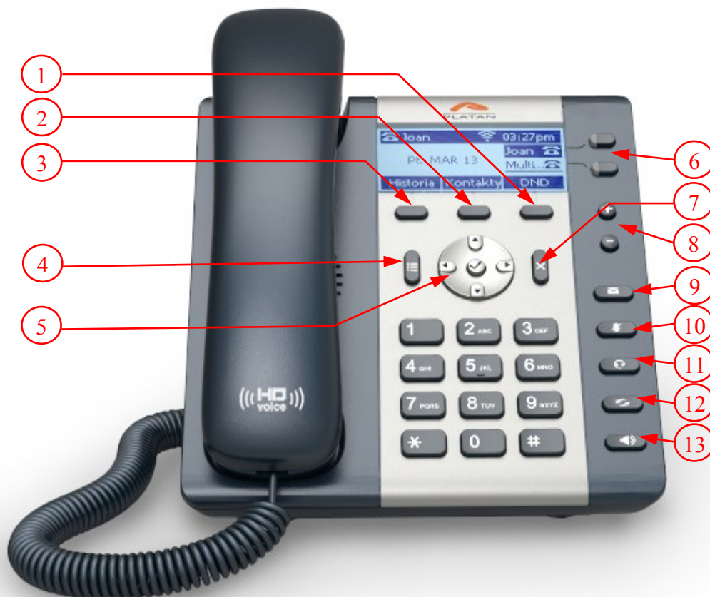
Rys. 1 Cyfrowy systemowy telefon IP Platan IP-T202W (z wi-fi)
